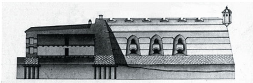
Эскарповый фасад правого фланка бастиона Петра II. Фрагмент чертежа «Профили через разные части вала Санктпетербургской Петропавловской крепости». РГА ВМФ. Ф. 3/л. Оп. 25. Д. 2010. 1797 г.
